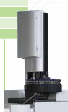
7650A 进样器最多可容纳 50 个样品
